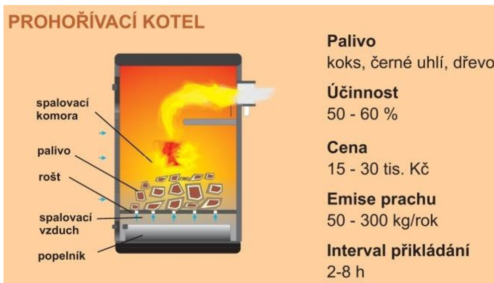
Obr. 1 Funkční schéma prohořivacího kotle
