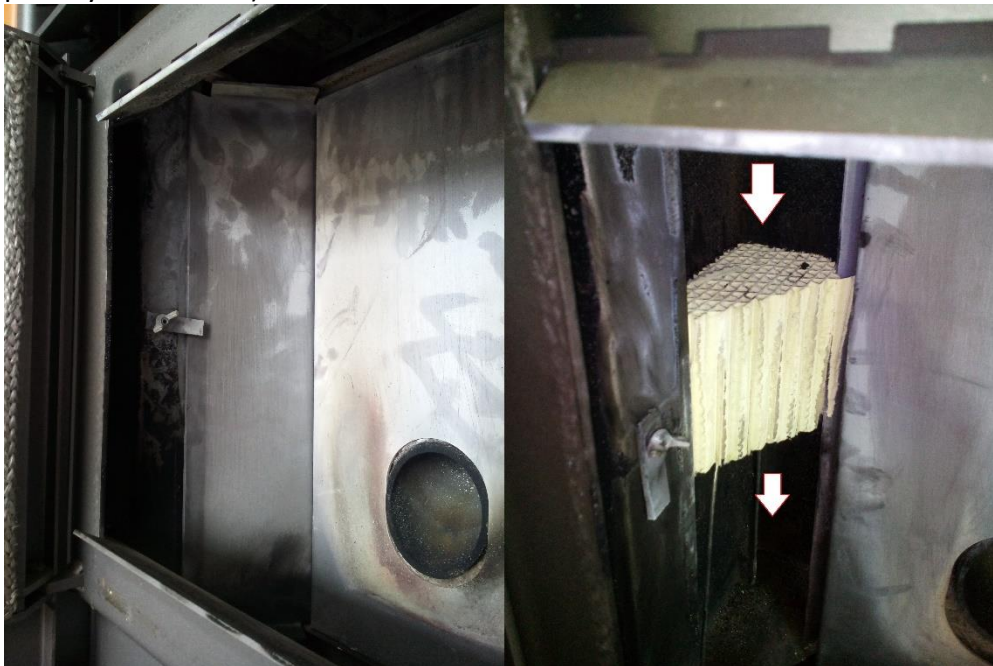
Obr. 5 Spalovací komora (vlevo); umístění katalyzátoru v druhém tahu (vpravo) - červené šipky vyznačují směr proudění spalin
