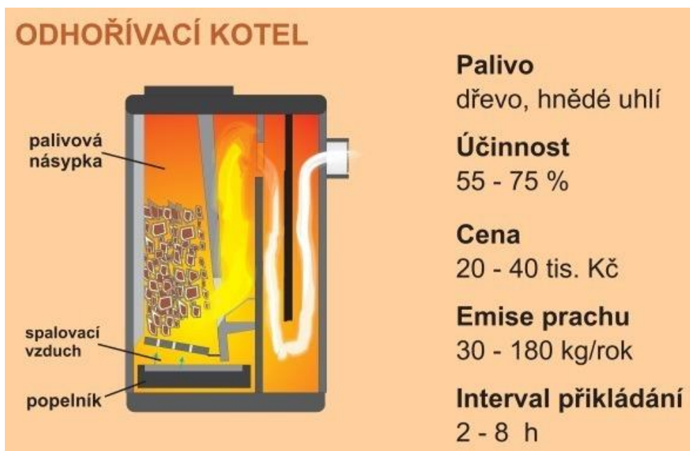
Obr. 2 Funkční schéma odhořivacího kotle
