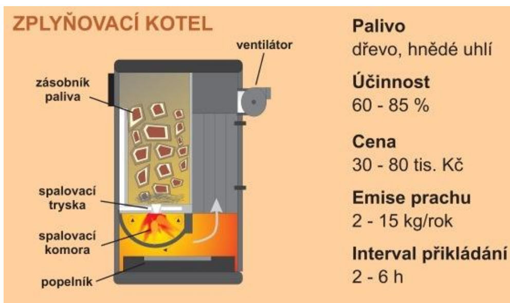
Obr. 3 Funkční schéma zplyňovacího kotle
