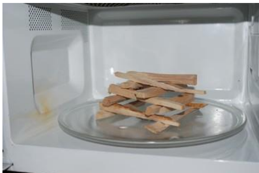
Obr. 2 Vzorek třísek před sušením v mikrovlnné troubě
