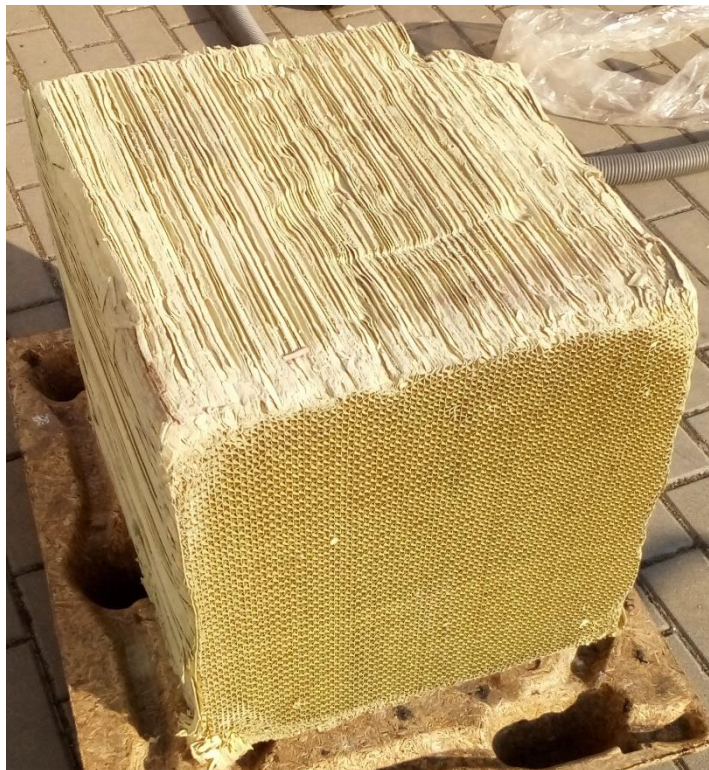
Obr. 2 Blok katalyzátoru před začátkem testování
