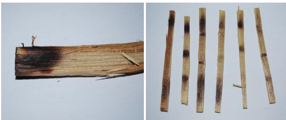
Obr. 3 Vzorky třísek, které byly „sušeny“ zbytečně dlouho – vzorek dřeva sušte tak, abyste tohoto vzhledu nikdy nedosáhli
