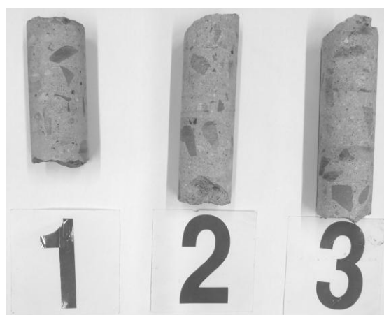
Foto č.3.2: Dokumentace vývrťů pro destruktivní zkoušky pevnosti v tlaku betonu
