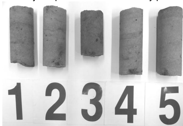
Foto č.3.1: Dokumentace vývrtů pro destruktivní zkoušky pevnosti v tlaku kamene
