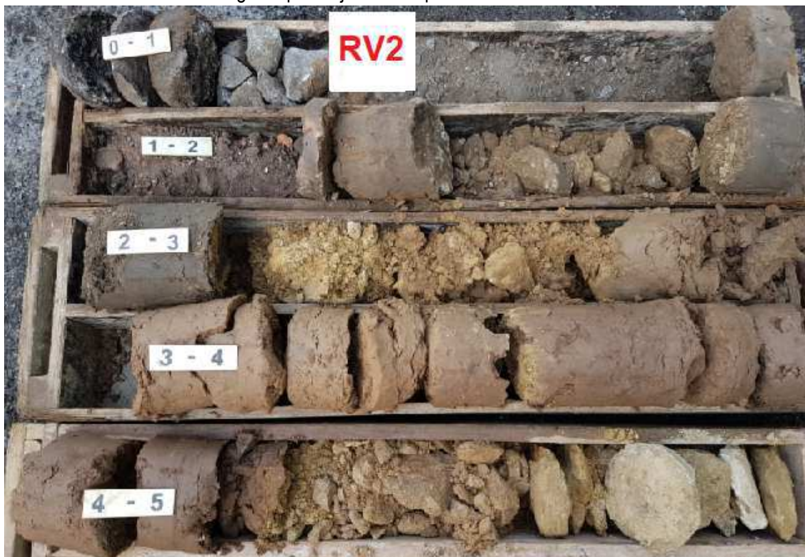
Fotografie profilu jádrového průzkumného vrtu RV 2
