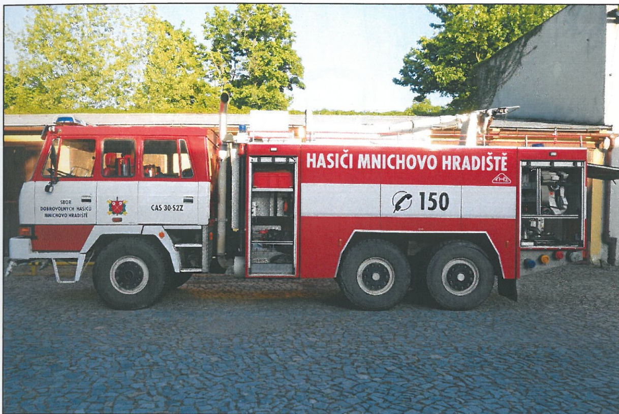
Vozidlo T 815 6x6 CAS 32, RZ: 7S1 8141 - boční levý pohled (otevřené rolety skříní příslušenství)
