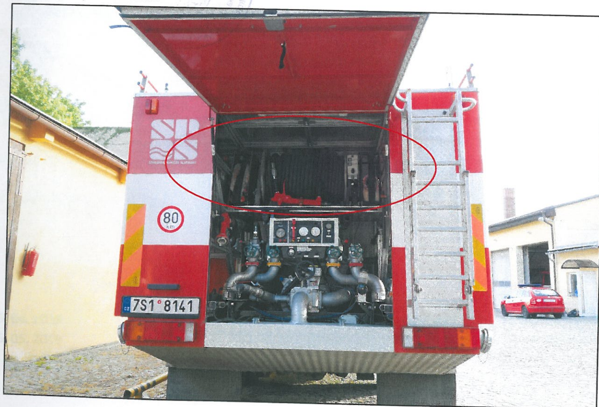
Vozidlo T 815 6x6 CAS 32, RZ: 7S1 8141 - zadní pohled do otevřené skříně výbavy, v horní části zařízení pro prvotní zásah
